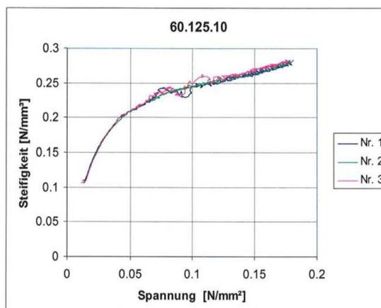
Dynamische Steifigkeit bei Mittellasten von 0.4 bis 4 kN und Frequenzen von 5 bis 40 Hz
